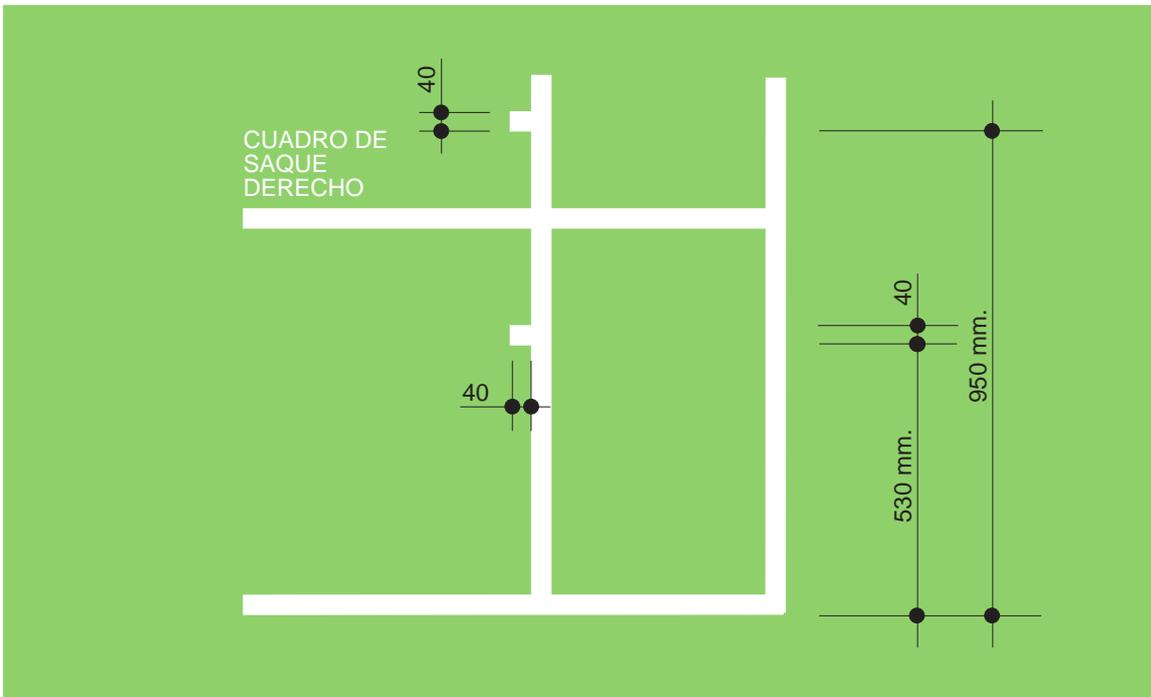
MARCAS PARA PRUEBA DE VELOCIDAD DEL VOLANTE
