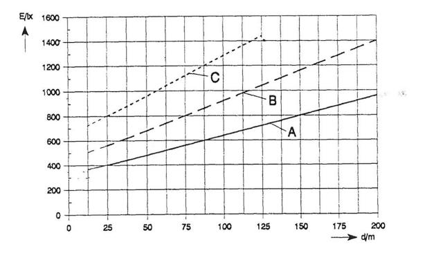
Nivel de iluminación vertical a mantener en función de la distancia máxima de tiro de las cámaras (UNE-EN 12193)
